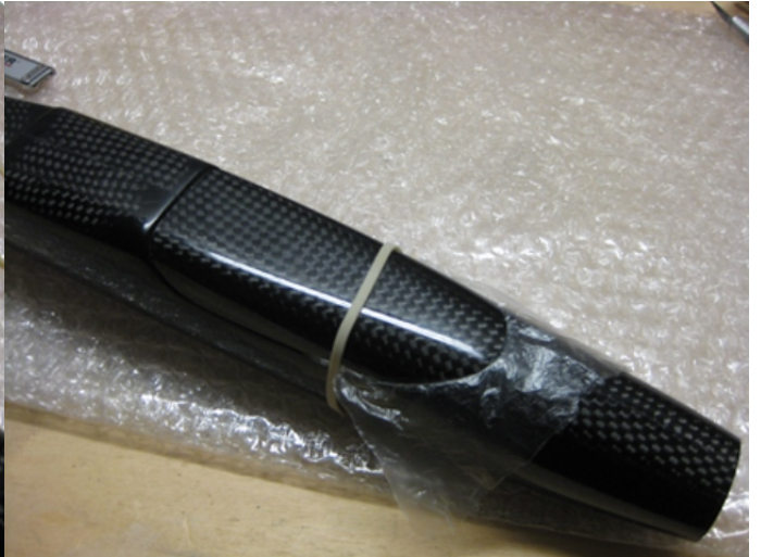
Verarbeitung und Fixierung - Rumpf und Kabinenhaube mit Plastikfolie trennen
