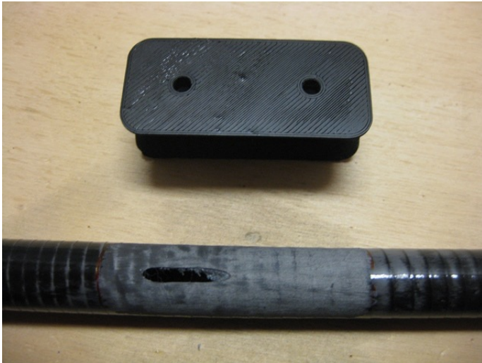
Vor dem Verkleben HLW-Halter und Rumpf aufrauen und Bowdenzug vorbereiten
