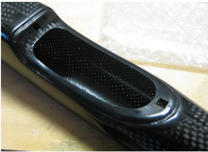
Vorbereitung im Rumpf zum Einkleben von Magneten
