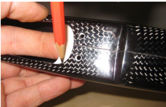
Platte vorbereiten - Rumpfverlauf anzeichnen - auf korrekte Position achten!
