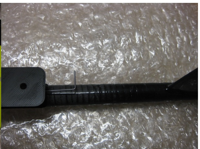
Ruderhorn für das Höhenruder mit Epoxy einkleben (ca. 1.5 mm links versetzt) Eine „L“-Biegung gegen rechts ist ausreichend - der Draht kann nirgendwo hin. Mittelstellung des HR-Servos prüfen (mittleres Loch Ruderhorn).
