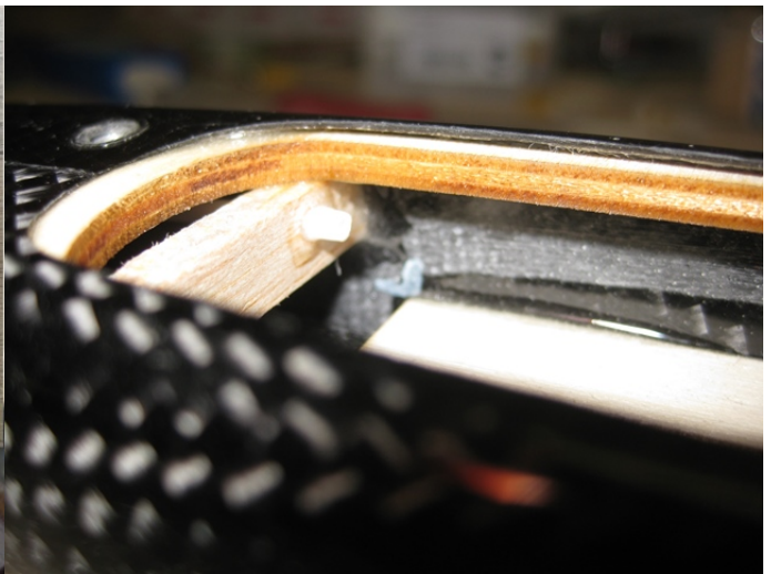
Bowdenzugrohre auf ca. 5 mm zurück kürzen und in Halterung einkleben
