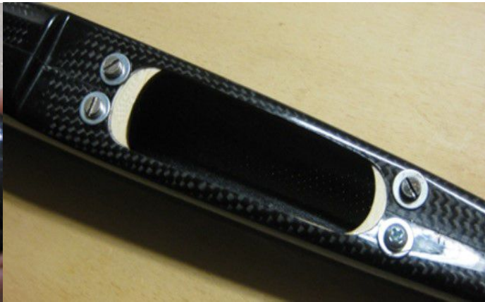
Mit Schrauben sichern
