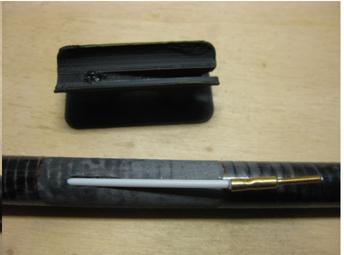
Vor dem Verkleben HLW-Halter und Rumpf aufrauen und Bowdenzug vorbereiten
