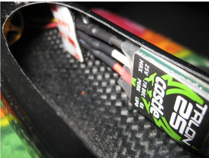
Regler mit 3M Dual Lock sichern. Motorkabel ebenfalls mit 3M Dual Lock sichern.
