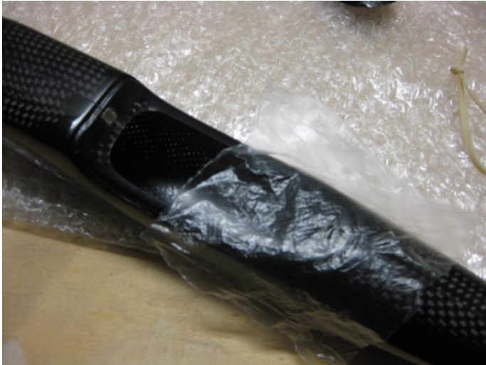
Verarbeitung und Fixierung - Rumpf und Kabinenhaube mit Plastikfolie trennen
