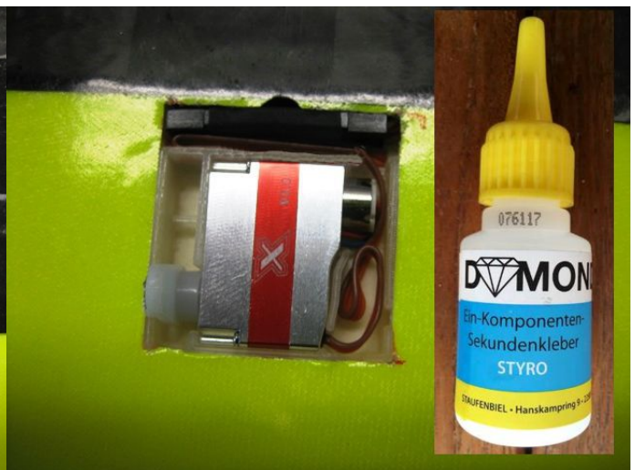
Servostecker anbringen. Angeschlossenes Servo mit gefaltetem Kabel im vorbereiteten Servoschacht mit 2 Tropfen Klebstoff verkleben (Styroporkleber verwenden!)
