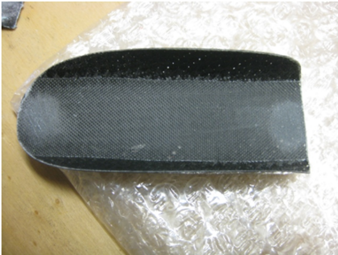
Positionen für Haubenmagnete aufrauen. Klebestelle für Motorspant aufrauen.
