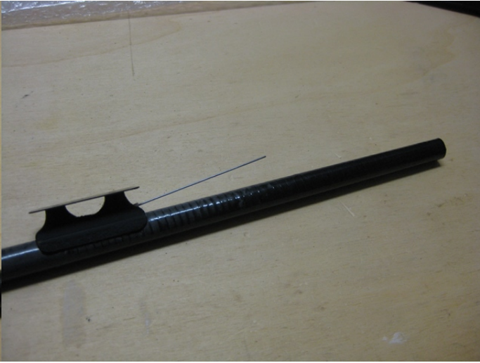
Mit dickflüssigem Sekundenkleber oder Epoxy verkleben.
