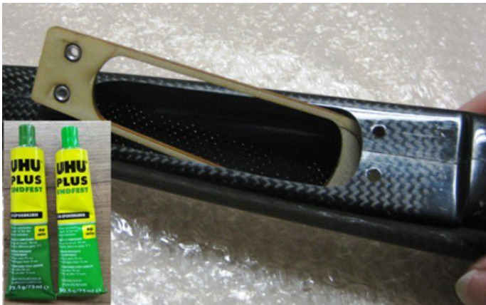
Platte einsetzen und mit Epoxy verkleben
