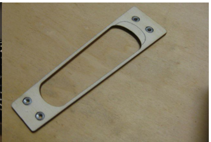
Platte vorbereiten - Rumpfverlauf anzeichnen - auf korrekte Position achten!
