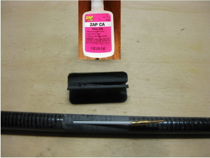
Mit dickflüssigem Sekundenkleber oder Epoxy verkleben.
