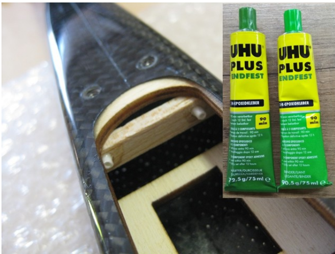
Bowdenzugrohre auf ca. 5 mm zurück kürzen und in Halterung einkleben
