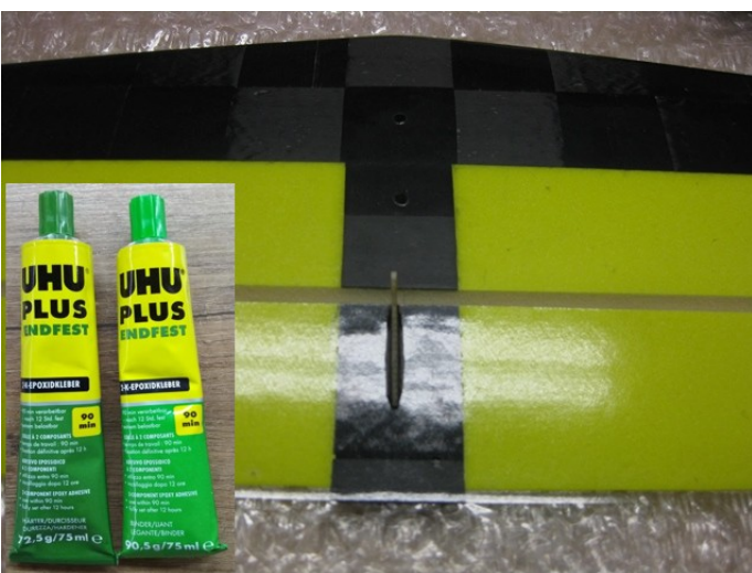
Ruderhorn für das Höhenruder mit Epoxy einkleben (ca. 1.5 mm links versetzt) Eine „L“-Biegung gegen rechts ist ausreichend - der Draht kann nirgendwo hin. Mittelstellung des HR-Servos prüfen (mittleres Loch Ruderhorn).
